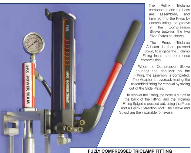
PRESS TRICLAMP ADAPTOR TRICLAMP FITTING **COMPRESSION SLEEVE** SLIDE PLATES
